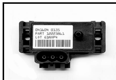
شکل ۷-۱ سنسور فشار هوا
