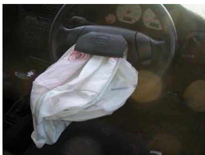
شکل ۹-۱۳ سیستم ایربگ بعد از عملکرد را نشان می دهد.
